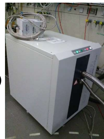
He-Rückgewinnung mittels Kompressor, in Forschungslabor der TUM (Garching)
